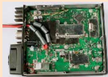
Einblick in die grundsätzliche Metallgusswanne des Grundgeräts: Wegen der Verwendung sehr kleiner und auf diesem Bild kaum erkennbarer SMD-Bauteile fallen in erster Linie die „handfesten“ Ferritringe über der Stromzuführung auf – der „Rest“ erscheint eher unspektakulär.
